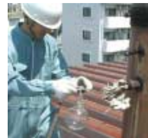
写真3 【NOxの測定】 フラスコを真空に減圧して排ガスを採取、吸収液に溶解させる
