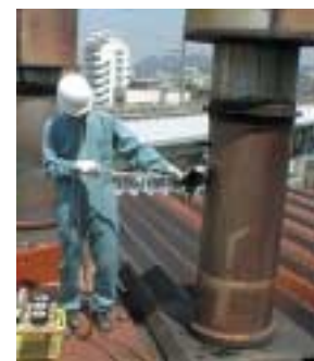
写真5 【ばいじんの測定】 フィルターを煙突に入れてばいじんを採取する
